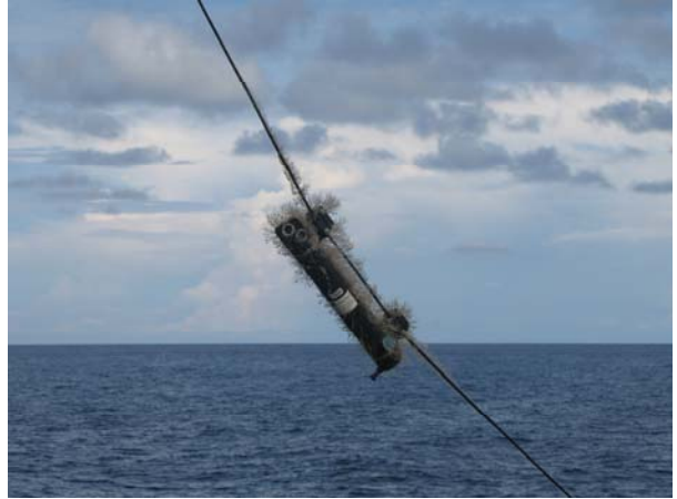
Aquadopp current meter
